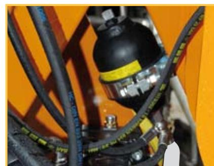
Ammortizzatore di sicurezza con accumulatore di azoto e ritorno automatico
